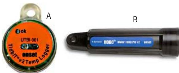
Gambar Perekam suhu : (a) Tidbit dan (b) HOBO WaterTemp Pro loggers
